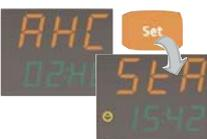
Для просмотра даны каждой из папок **rHC** откройте ее нажатием **set**. Первое значение с меткой **StA** на дисплее **PV** отображает время регистрации аварии. Этот дисплей через каждые 3 секунды переключается на дисплей с той же меткой **StA** но с индикацией даты регистрации аварии (см. иконку слева от значения).
