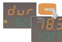
Еще раз нажмите **set** для отображения большей из температур, которые были непосредственно перед прерыванием питания и сразу после его восстановления (если это значение вышло за установленный температурный предел. Температура будет показана на дисплее **PV** с отображением метки **POFA** (**P**ower **F**ailure – прерывание питания) на дисплее **SV** (смотри пример).
