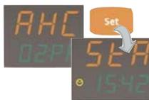
Для просмотра данных каждой из папок **AHC** нажмите **set**. Первым значением с меткой **StA** на дисплее **PV** отобразится момент регистрации аварии (на дисплее **SV** поочередно будет отображаться время (часы:минуты) и дата (число:месяц) с переключением индикации через каждые 3 секунды. Метка **StA** при этом остается неизменной.
