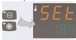
**3** Нажатием кнопок Вверх и Вниз Вы можете изменить значение Рабочей точки, которое отображается на **SV** дисплее
