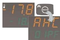
Удерживайте нажатой кнопку НАССР для открытия папки первой НАССР Аварии. Для пролистывания Аварий используйте кнопки **ВВЕРХ** и **ВНИЗ**. Прокрутите их до нахождения аварии с типом прерывания питания **PF** (см. пример). На дисплее **PV** появится метка **AHC**, а на дисплее **SV** отобразится номер аварии (в примере 1) и ее тип (**PF**)
