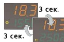
Вновь нажмите **set** для просмотра максимальной температуры во время зарегистрированной аварии (на дисплее **PV**) с отображением времени и даты (попеременно на дисплее **SV**).
