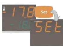
Папка Рабочей точки **Set** присутствует всегда. Папка аварий **ALr** видима при наличии аварии/й, папки датчиков **Pb1**, **Pb2** и **Pb3** при наличии этих датчиков, а папка часов **rtc** только при активности функции (см. **H48**).
