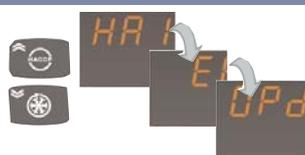
• При наличии аварий их метки можно просмотреть используя для пролистывания кнопки **ВВЕРХ** и **ВНИЗ**.
