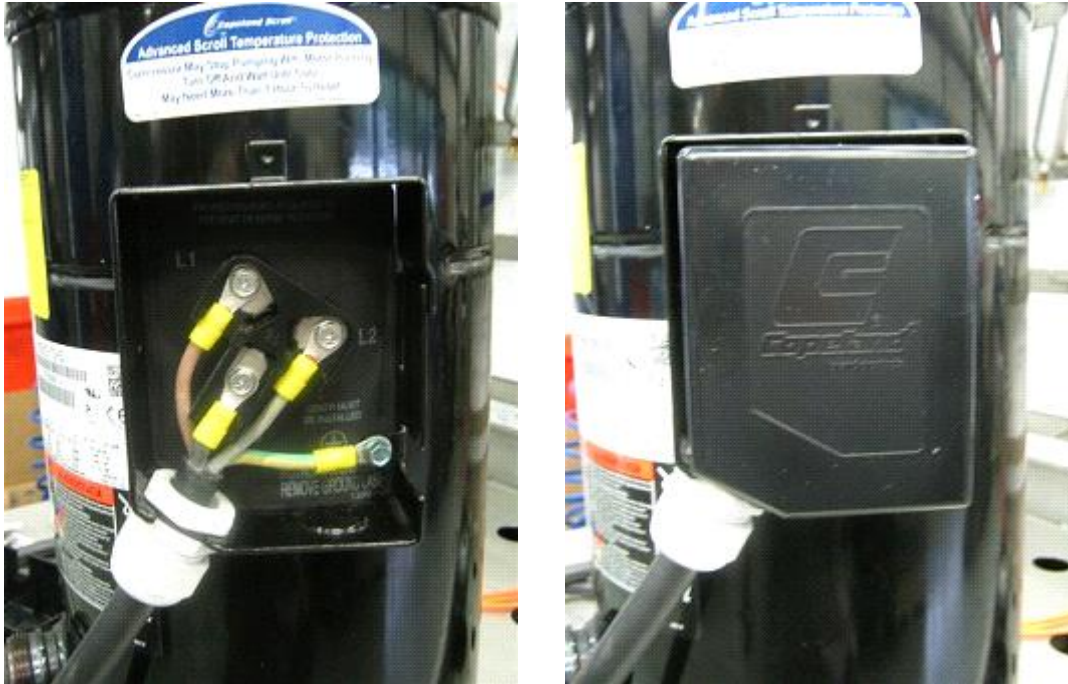
Рис. 18: Правильное подключение клеммной коробки IP21 с использованием кабельной муфты
