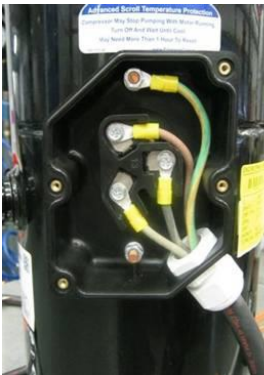
Рис. 20: Правильное подключение клеммной коробки IP54 с использованием кабельной муфты
