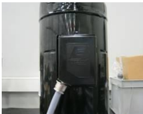
Рис. 21: Правильное подключение клеммной коробки IP66 с использованием кабельной муфты
