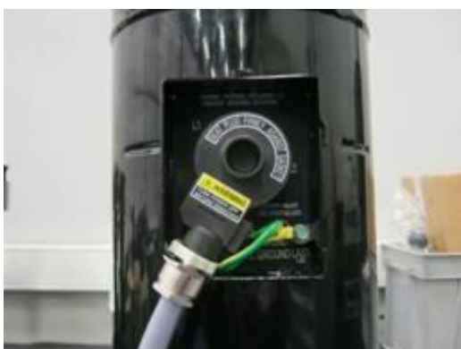
Рис. 21: Правильное подключение клеммной коробки IP66 с использованием кабельной муфты
