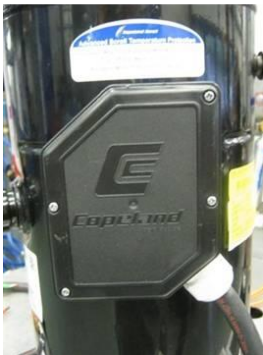
Рис. 20: Правильное подключение клеммной коробки IP54 с использованием кабельной муфты
